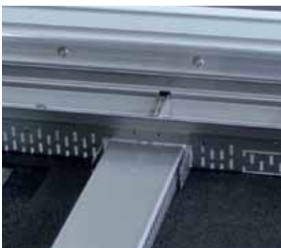
Inschuiven van de steekgoot in de goot. Aangeraden wordt om per meter goot lengte minimaal 2 zijgoten/steunen aan te brengen.
