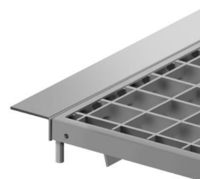
Kieradapter t.b.v. opvangen ruimte tussen rooster en muur standaard ca. 20 mm om eventuele oneffenheden in de muur op te vangen.
